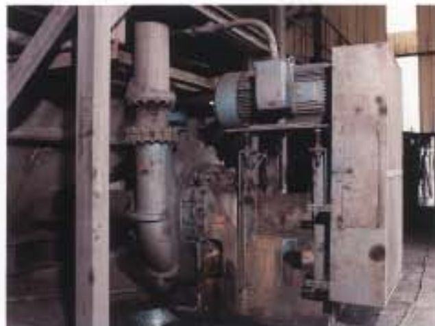
Модель 5500 с мотором и ременным двигателем на заводе подготовки угля на участке циклонного потока тяжелых взвесей.
