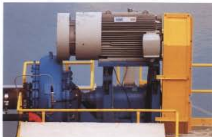
Модель 5500 с мотором (450 лошадиных сил), установленным сверху с ременным приводом, на одном из золотодобывающих заводов, перерабатывающий поток руды золота
